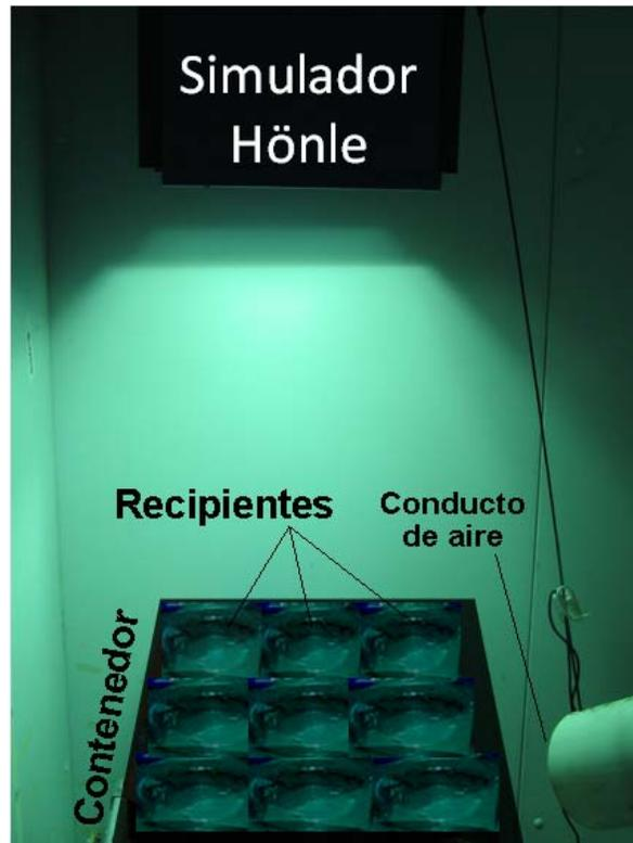
**Figura 1.1:** Esquema del dispositivo utilizado para los experimentos de exposición a la radiación bajo el simulador solar en condiciones controladas de temperatura.
